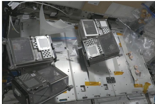
植物サンプルを設置、培養するための装置 Image by JAXA/NASA
