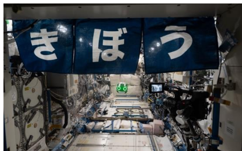
「きぼう」船内実験室（PM）内で飛行するInt-Ball2 Image by JAXA/NASA
