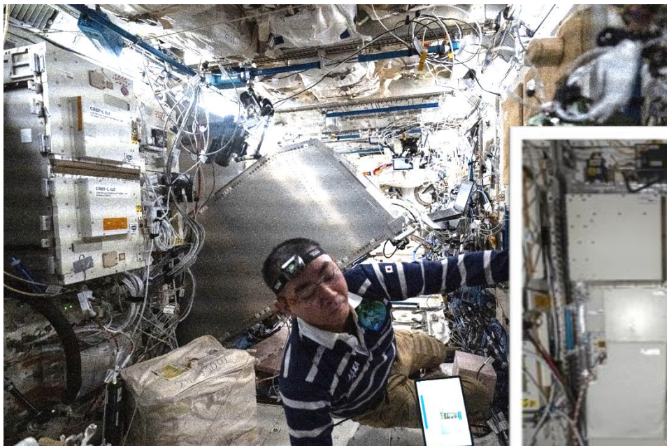
実験ラックを前方に傾け二酸化炭素除去装置の組込準備をする 油井宇宙飛行士 Image by NASA/JAXA
