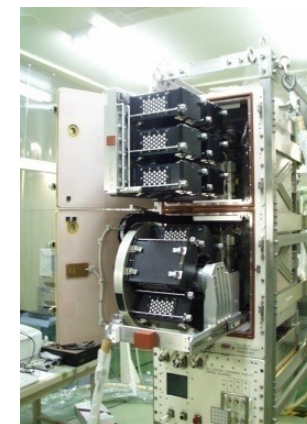
植物サンプルを設置、培養するための装置 植物実験ユニット (Plant Experiment Unit: PEU) Image by JAXA
