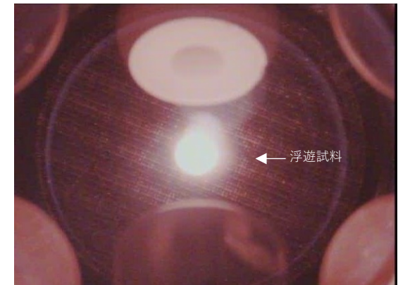
ELF内で高温液体酸化物が浮遊する様子：帯電した試料と周囲の電極間に働くクーロン力を利用して試料の浮遊・位置制御が行われる。Image by JAXA
