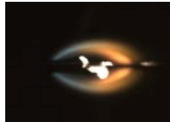
「きぼう」での軌道上実験で取得された、薄い“ろ紙”試料上を燃え広がる火炎の画像 Image by 弘前大学、岐阜大学、北海道大学、JAXA
