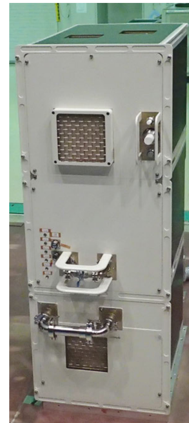
二酸化炭素除去システム軌道上実証のフライト品 Image by JAXA
