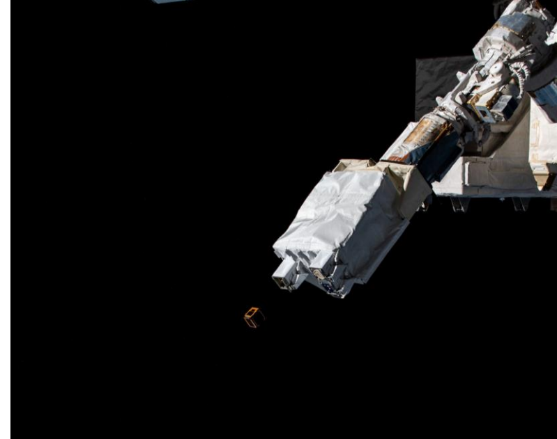
J-SSOD#23で放出された超小型衛星 (Image by JAXA/NASA)
