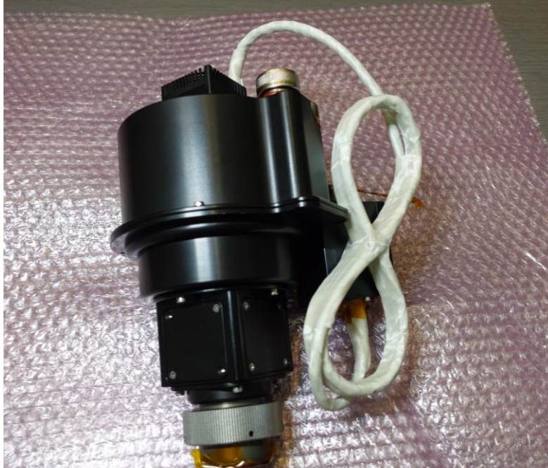
若田宇宙飛行士が取り付けした高速度カメラ (Image by JAXA)
