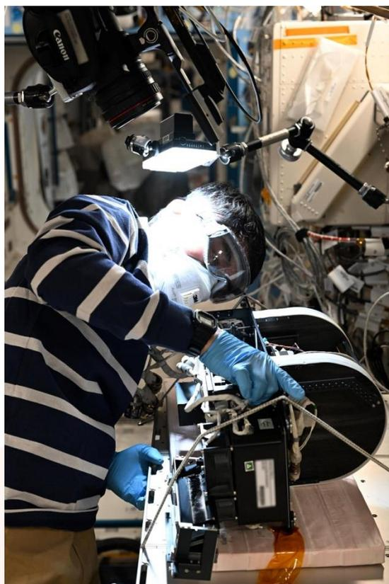
固体燃焼実験装置(SCEM)の実験試料交換作業を実施する大西宇宙飛行士
