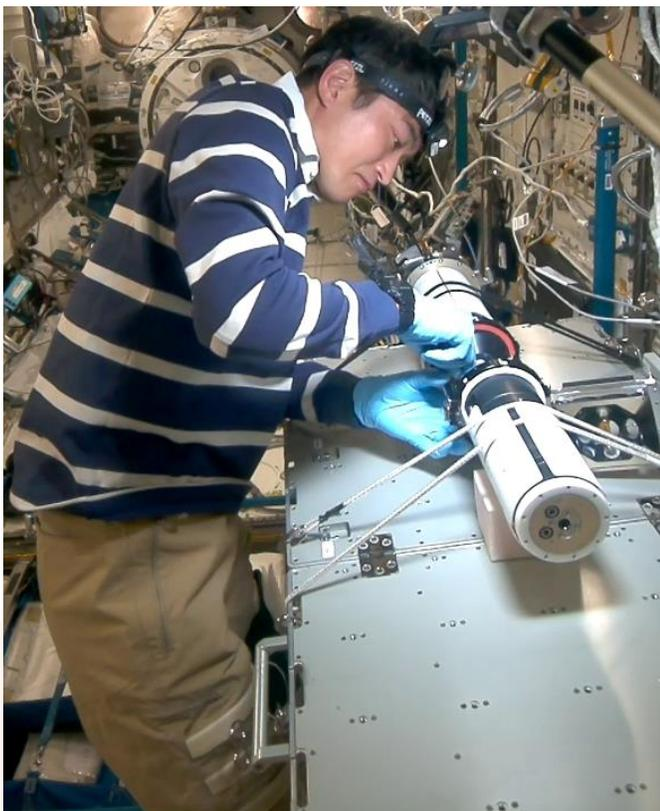
JEM船内可搬型ビデオカメラシステム実証2号機 (Int-Ball2) が撮影した静電浮遊炉 (ELF) の炉内清掃を行う大西宇宙飛行士の様子
