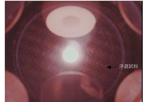
ELF内で高温液体酸化物が浮遊する様子：帶電した試料と周囲の電極間に働くクーロン力を利用して試料の浮遊・位置制御が行われる。Image by JAXA
