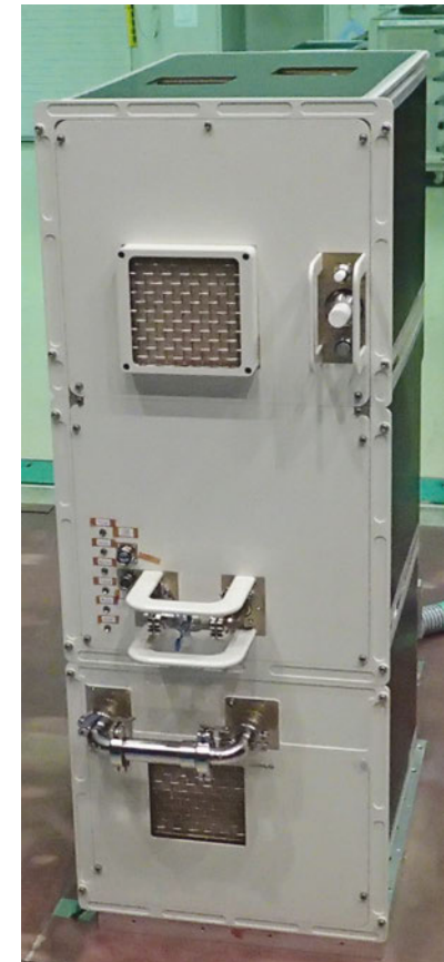
二酸化炭素除去システム軌道上実証のフライト品 Image by JAXA
