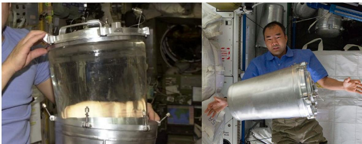
図 5.1-5 ロシアの水容器(EDV タンク) (©NASA)
