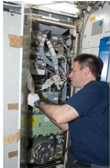
図 5.2-2 米国の酸素生成装置 (OGS) (©NASA)
