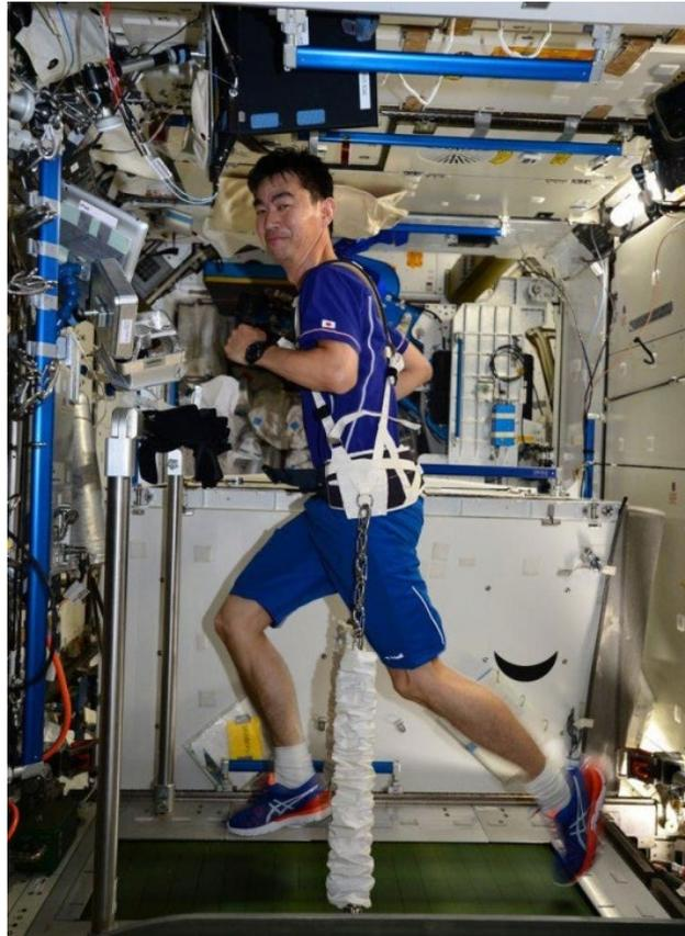
図4.3-2 ノード3内に設置されたT2「COLBERT（コルベア）」を使ったエクササイズ（©JAXA）
