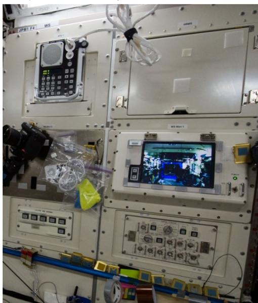
画像データ等を切り替える機器、音声通信端末、TV モニタ 2 台(1 台は未装着)、警告警報パネルなどを装備しています。
