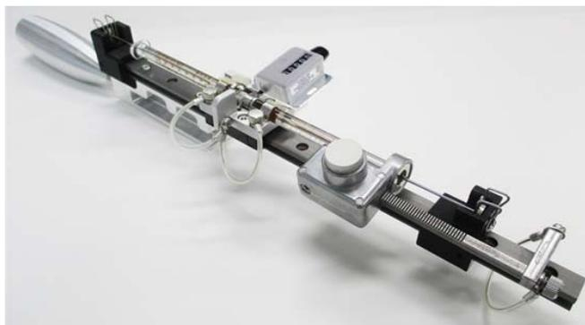
図 2.3-4 膜タンパク質結晶化用器具
