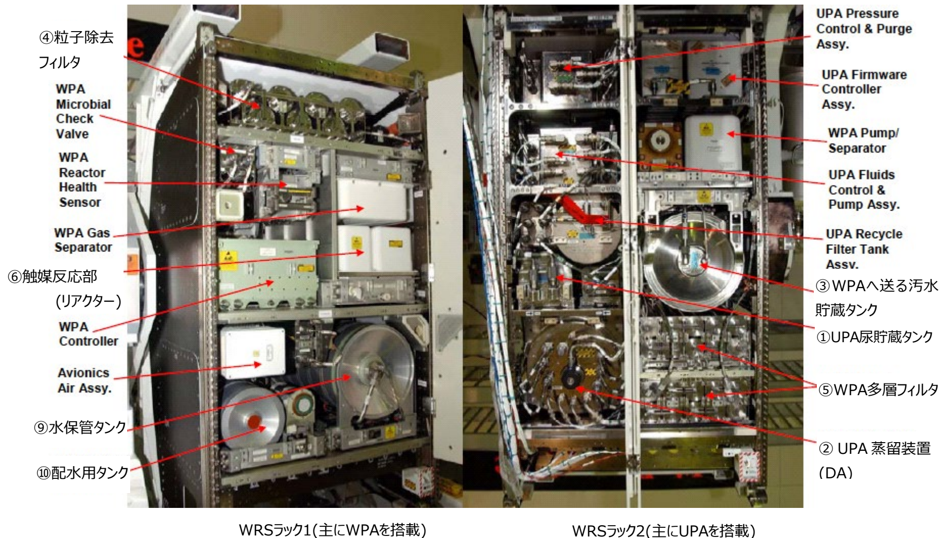
図 5.1-1 WRS1, 2 ラックの機器構成(©NASA)
