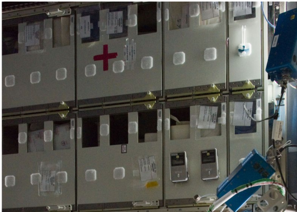
図 4.3-7 デスティニー内のクルー健康管理システムラック(ChCS2 ラック) (©NASA)
