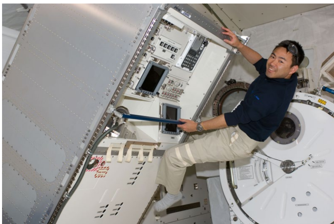
図 4.4-5 「きぼう」内でのラックの搬入・設置作業（©NASA/JAXA）
