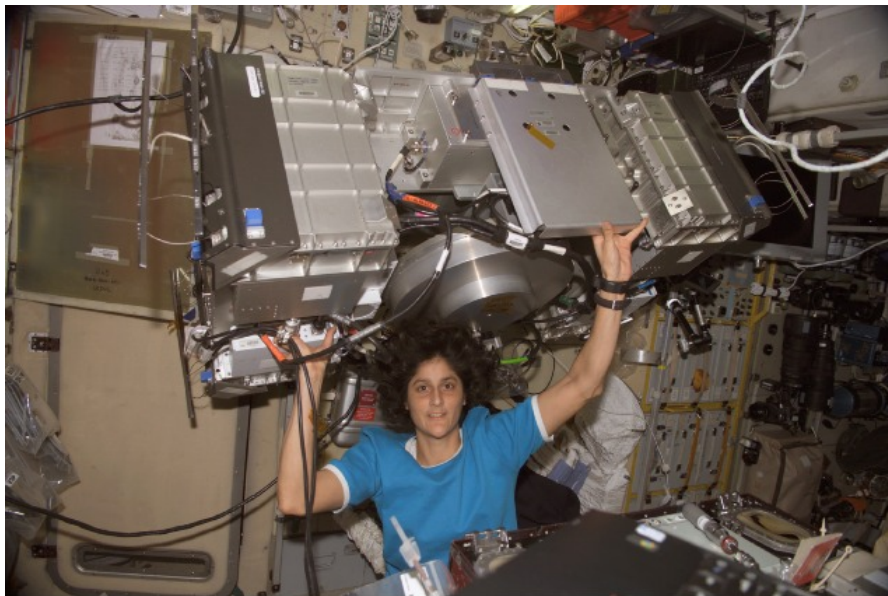
図 4.4-1 TVIS の修理（床下の機器を取り出した状態:2007 年 2 月）（©NASA） https://spaceflight.nasa.gov/gallery/images/station/crew-14/html/iss014e15350.html
