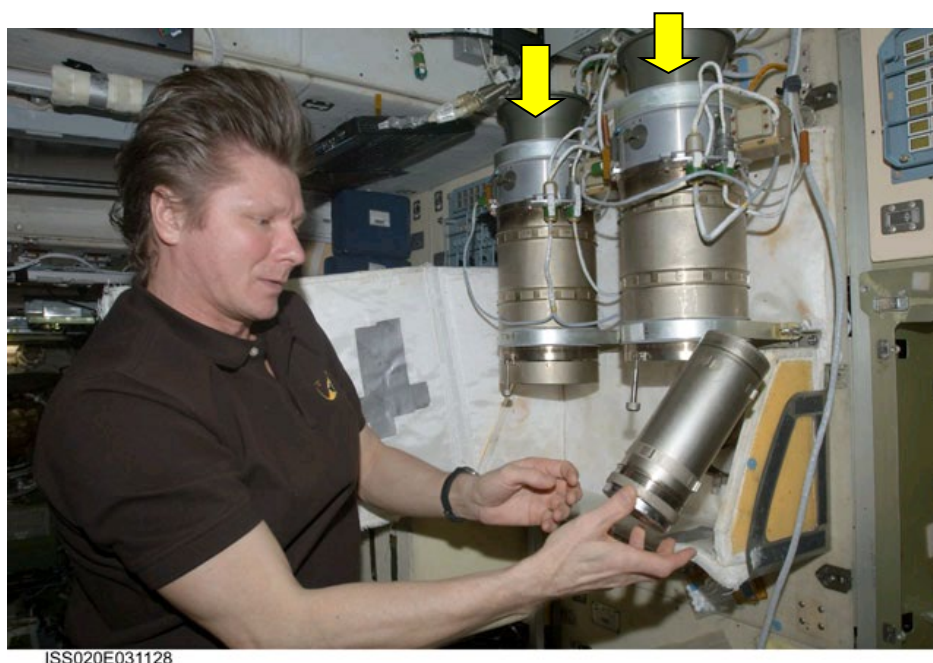
図 5.2-3 ズヴェズダ内に設置されている SFOG 容器 2 本 (矢印) (©NASA) https://spaceflight.nasa.gov/gallery/images/station/crew-20/html/iss020e031128.html
