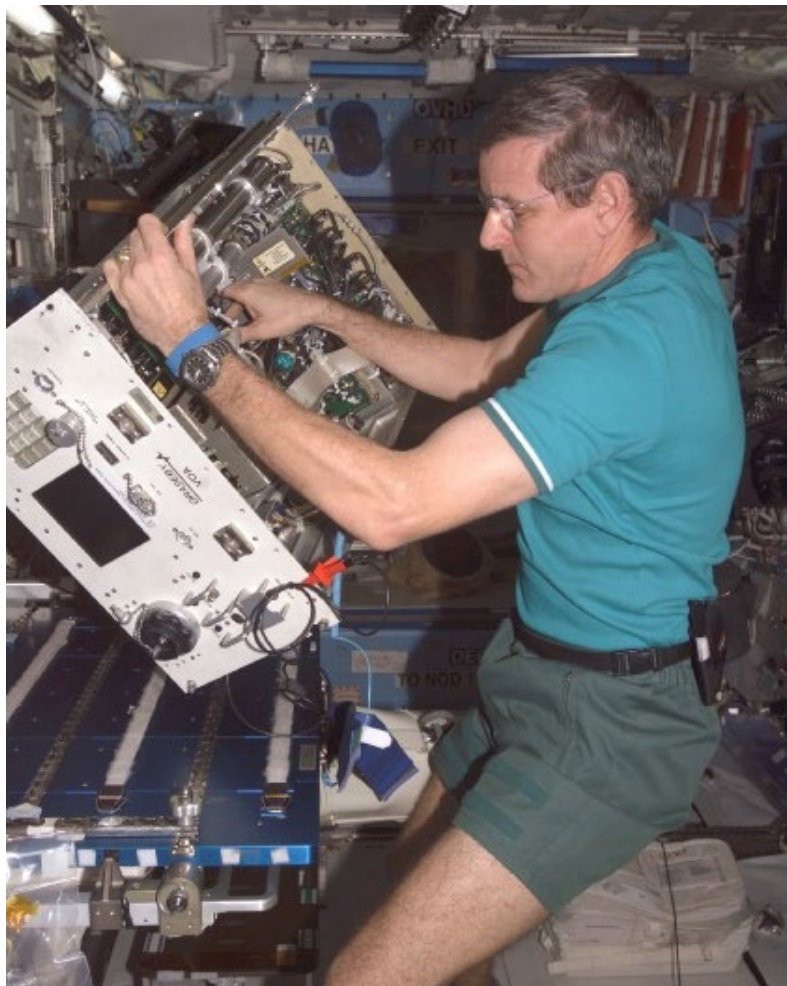
図 4.4-3 故障した装置(揮発性有機物分析器(VOA))の修理 (©NASA)
