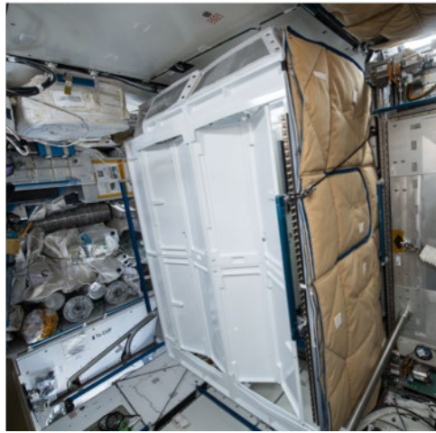
図 4.1-7 米国のトイレ (左側が UWMS、右側が WHC) (©NASA)
