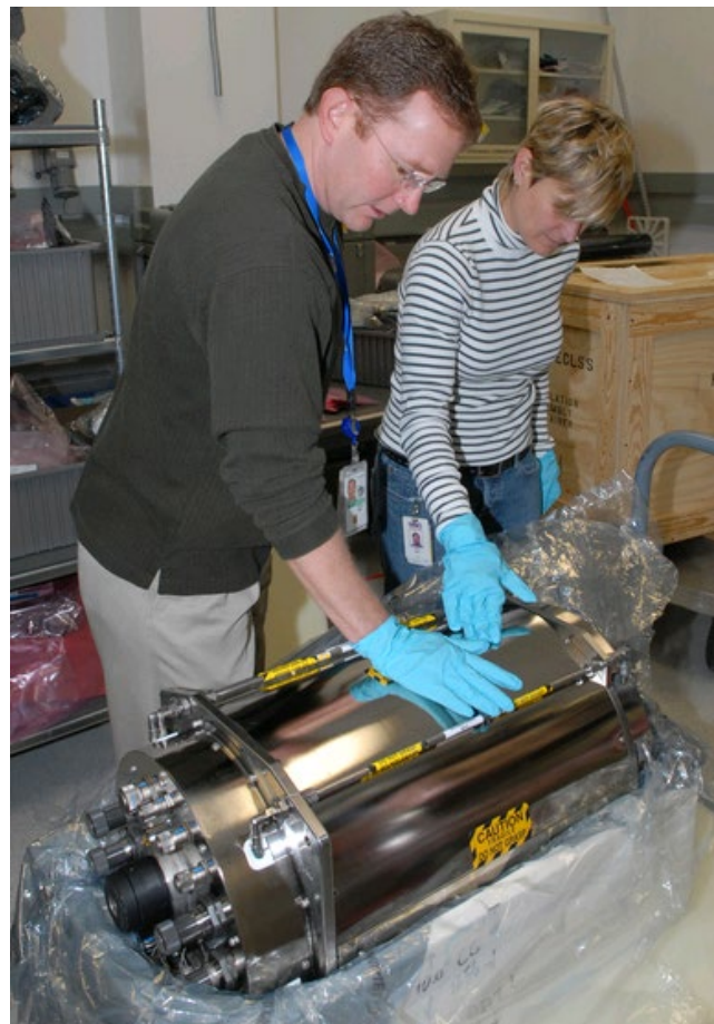
図 5.1-4 STS-119 で運ばれた交換用の Distillation Assembly (DA) (©NASA KSC)
