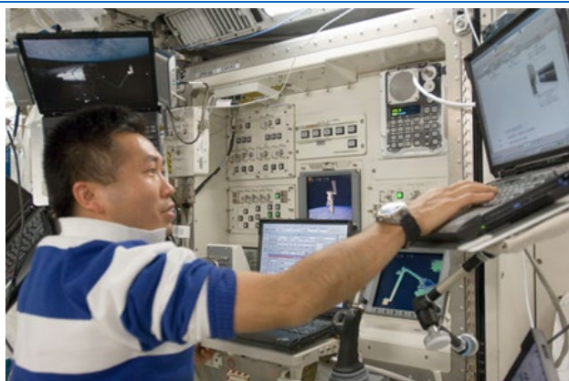
図 1-10 「きぼう」ロボットアーム制御ラック (© NASA)
