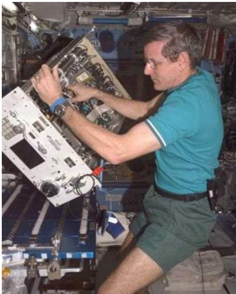
図 4.4-3 故障した装置（揮発性有機物分析器（VOA））の修理 (©NASA)
