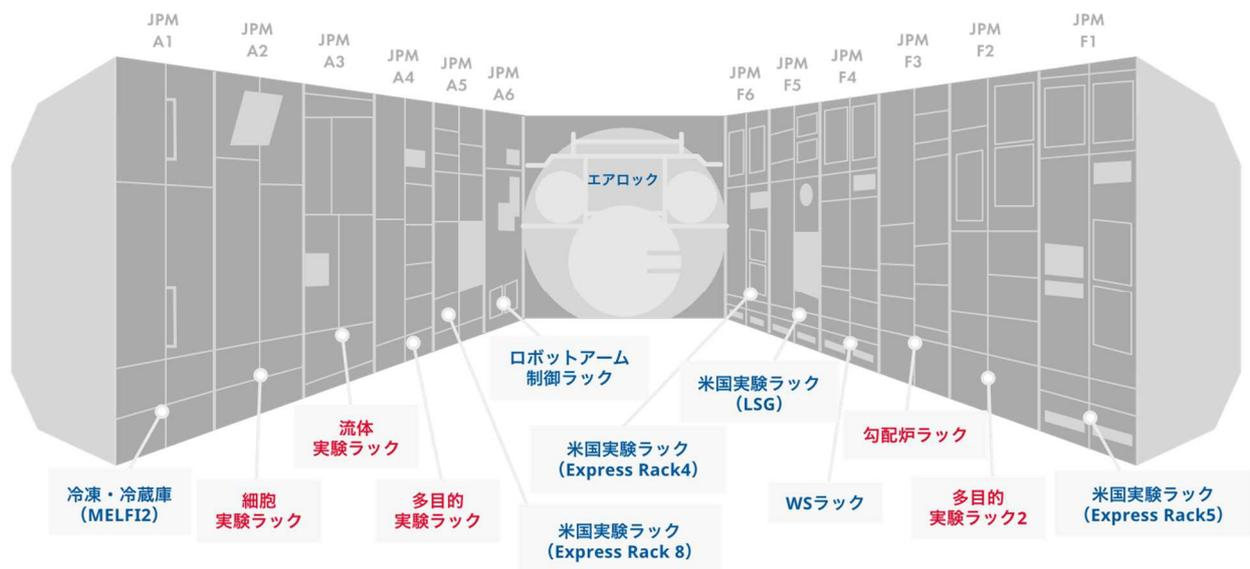
図 4.2-1 船内実験室のラックの配置（©JAXA）
