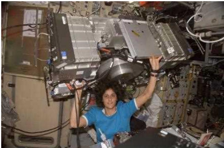
図 4.4-1 TVIS の修理（床下の機器を取り出した状態:2007年2月）（©NASA）
