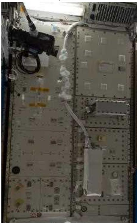
ICS ラックは、データ中継技術衛星「こだま (DRTS)」を使用して「きぼう」と筑波宇宙センター間の通信を行うための通信機器を搭載しています。（注：「こだま」は、2017 年 8 月 5 日に運用が終了しました。）
