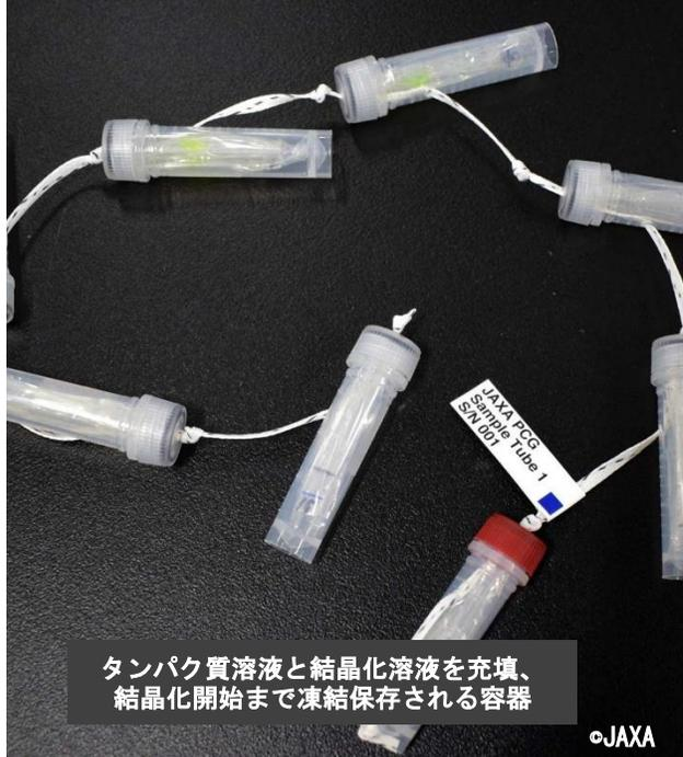
タンパク質溶液と結晶化溶液を充填、
