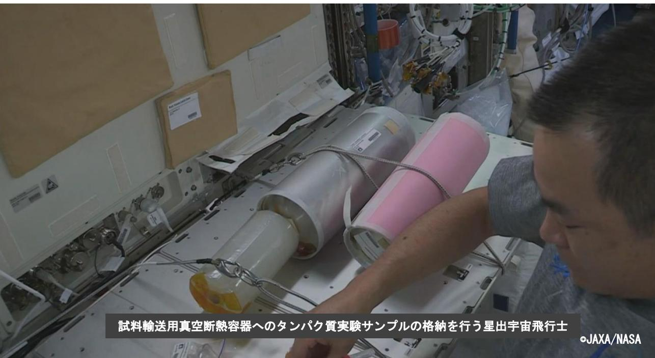
試料輸送用真空断熱容器へのタンパク質実験サンプルの格納を行う星出宇宙飛行士
