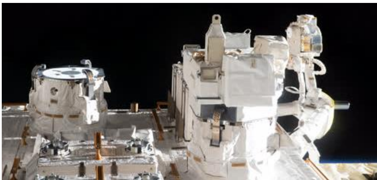
船外実験プラットフォーム（EF）に取り付けられた中型曝露実験アダプタ（i-SEEP2） Image by JAXA/NASA
