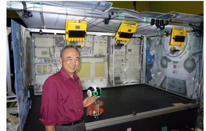
地上試験中のInt-Ball2プロトフライトモデルと古川宇宙飛行士 Image by JAXA
